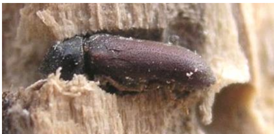
Fot. 25 Chrzęszcz KOŁATEK DOMOWY( Anobium domesticum ) wygryza kanał o średnicy 2-3 mm w części bielastej drewna (powiększenie)
